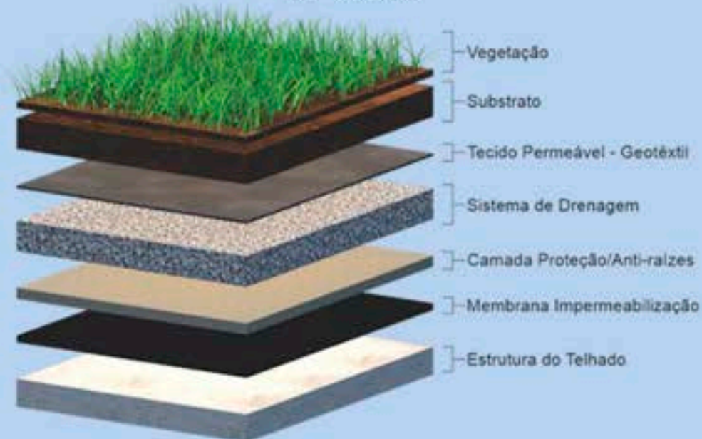
Figura 136 - Camadas que compõem um telhado verde.
